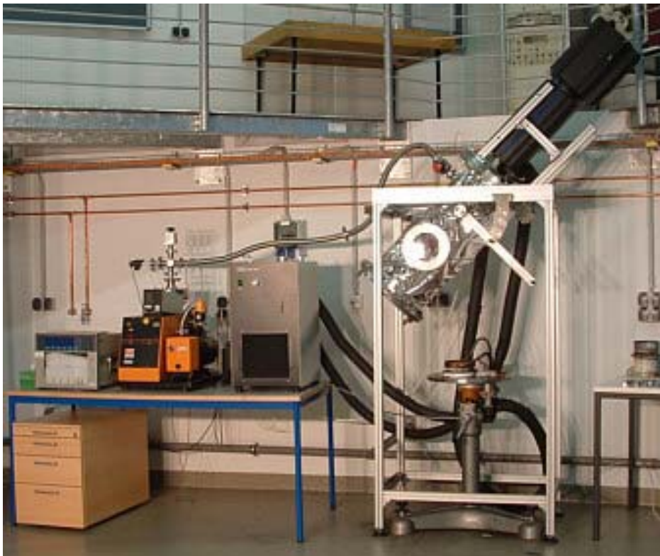
Pumpstand zur Erzeugung des Vakuums und ein Bad-Kryostat zum Kühlen der Kammer
