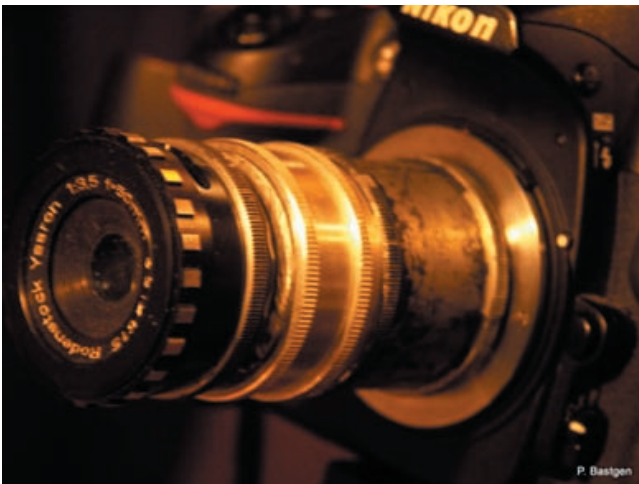
Abb. 2. Kamera mit Zwischenringen und Objektiv
